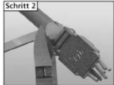
Kabelbinder auf Zugentlastung anbringen und die Überlänge entsprechend abschneiden.
