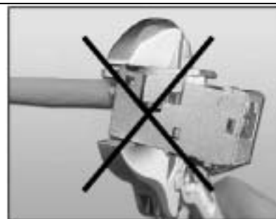
Wird die Zange zu weit hinten angesetzt, kann es passieren, dass das Ladestück verrutscht und die Schneidklemmen im inneren des Moduls beim Zusammendrücken beschädigt werden.
