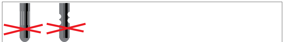
Abbildung 3.3 Beschädigte Stifte mit Kerben oder Kratzern
