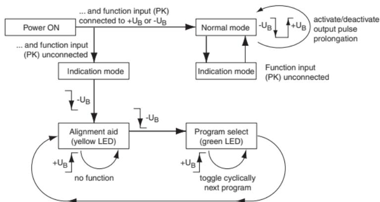
Bild 5.1: Parameter assignment
