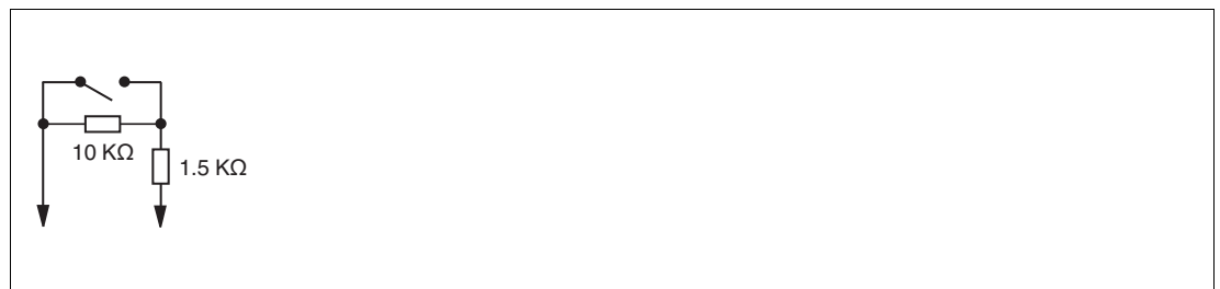
Abbildung 8.89 Widerstandsnetzwerk für Leitungsfehlerüberwachung
