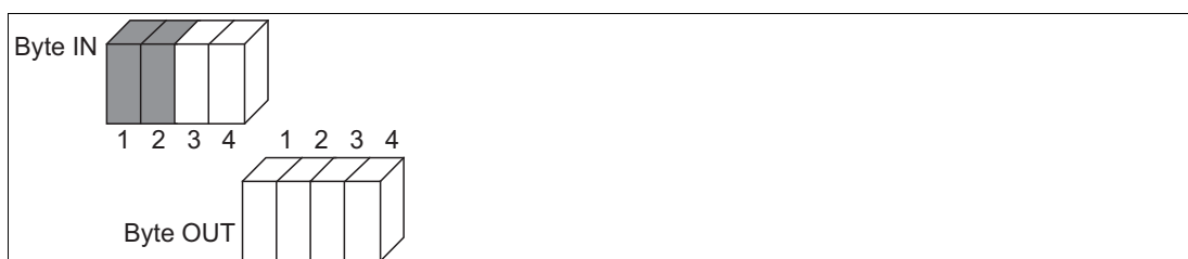
Abbildung 3.4 Universalmodul 4I4O das mit 2 Byte Eingangsdaten belegt ist
