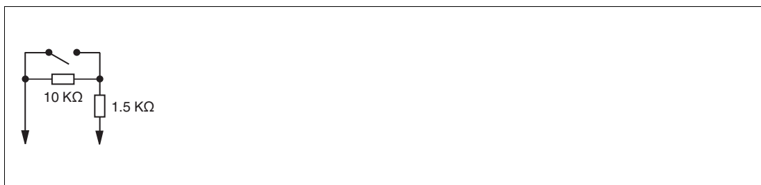
Abbildung 8.8 Widerstandsnetzwerk für Leitungsfehlerüberwachung
