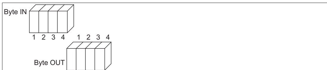
Abbildung 3.3 Universalmodul 4I4O mit 4 Byte Eingangsdaten und 4 Byte Ausgangsdaten
