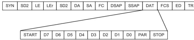
Abbildung 2.3: Aufbau des Profibus-Telegramms
