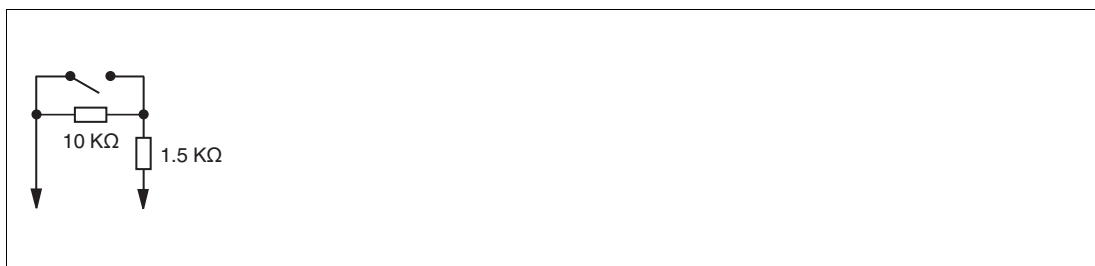
Abbildung 6.50 Widerstandsnetzwerk für Leitungsfehlerüberwachung
