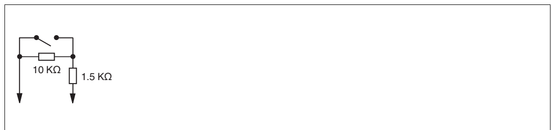
Abbildung 6.3 Widerstandsnetzwerk für Leitungsfehlerüberwachung
