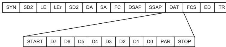
Bild 2.3: Aufbau des Profibus-Telegramms
