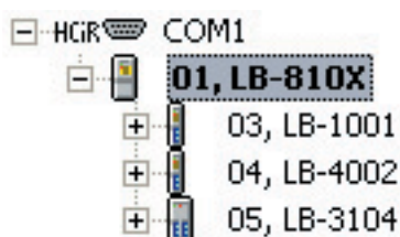
Bild 7.16: Markierte Remote-I/O-Station in der Baumstruktur
