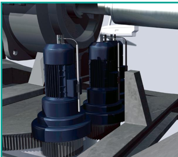
为了使涡轮机能够产生尽量多的电能，风轮总是面对风向，机舱旋转到一个特定的角度，并且避免因强风导致机舱故障，从而增加成本甚至停工。
