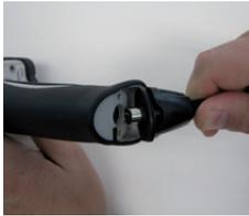
4. Drücken Sie den 8-poligen Din-Stecker samt Distanzscheibe und Schutzkappe auf die Anschlussbuchse.
