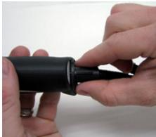
5. Schrauben Sie mit Hilfe eines Schraubendrehers und den mitgelieferten Schrauben die Schutzkappe auf der Unterseite des Handgriffs fest.
