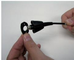
Sobald die Distanzscheibe auf dem DIN-Stecker einrastet, ist sie richtig montiert.
