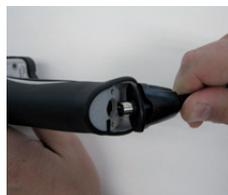
3. Drücken Sie den 8-poligen DIN-Stecker und Schutzkappe auf die Anschlussbuchse.
