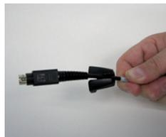
2. Richten Sie den 8-poligen DIN-Stecker so aus, dass er in die Anschlussbuchse am Handheld passt.
