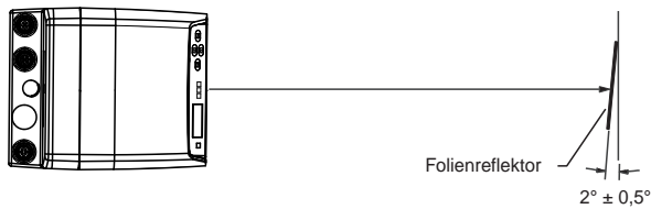
Bild 5.6: Anordnung des Folienreflektors (VDM-Draufsicht)
