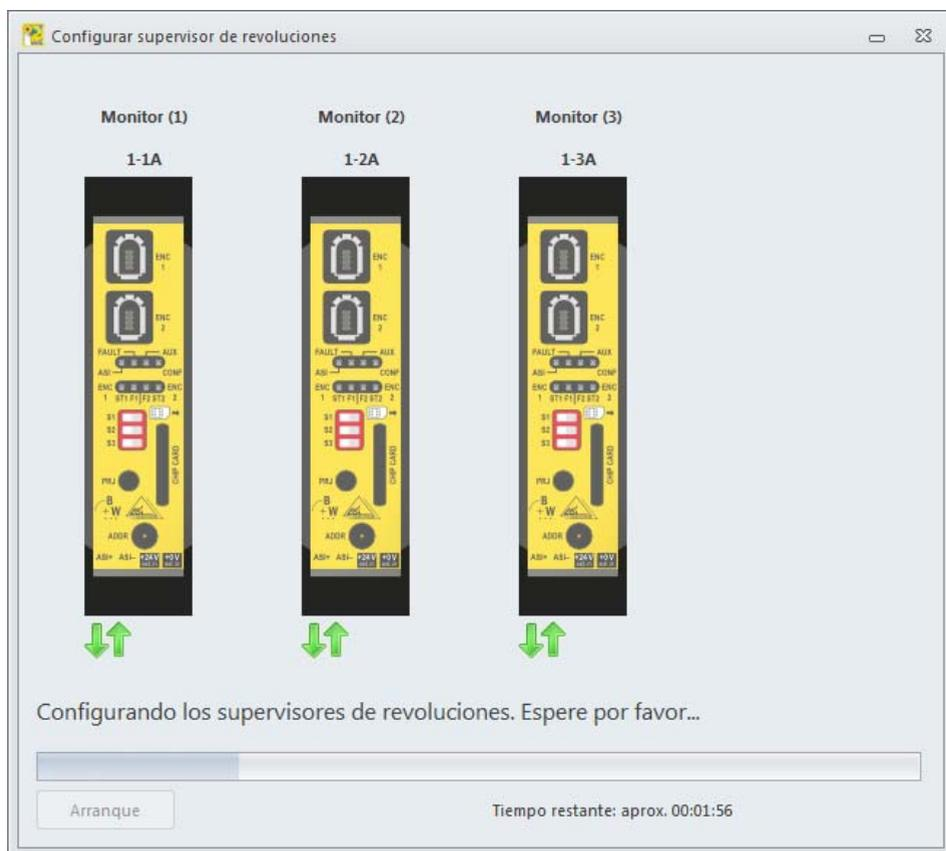
Tras finalizar la configuración de todos los supervisores de revoluciones se puede cerrar la ventana con **Salir** o cambiar al modo de prueba con **Examinar**.
