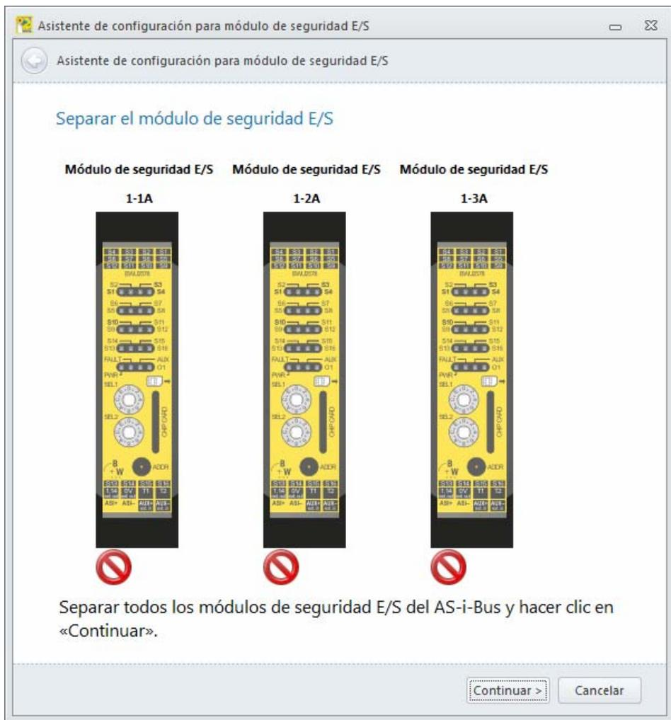
Asistente de configuración para módulo de seguridad E/S
