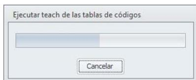
Si no todos los esclavos AS-i de seguridad pueden pasar simultáneamente al estado conectado (ON), aparecerá la siguiente ventana, en la cual se indica gráfica y sinópticamente el avance del aprendizaje.
