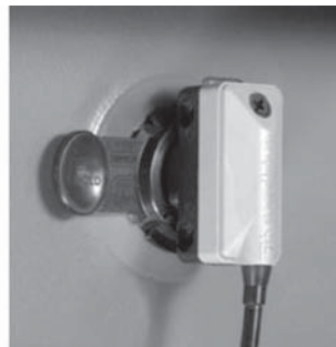
3. 顺时针方向旋转90度, 以进行固定
