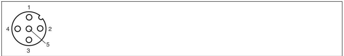
Pinbelegung der M12-Buchse für RS 232
