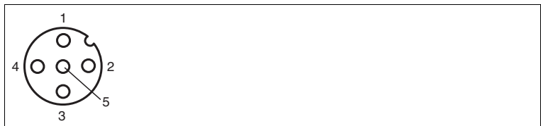
Pinbelegung der M12-Buchse für RS 232
