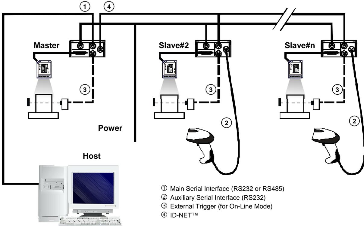
Figure 66 – Pass-Through On ID-NET™ Layout
