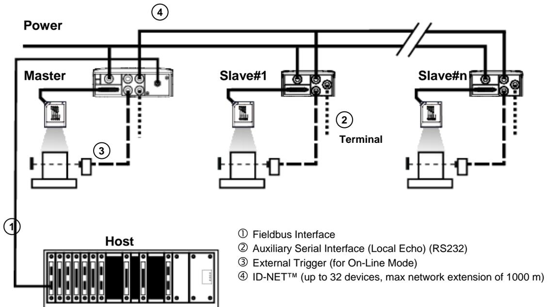
Figure 70 – ID-NET™ Fieldbus M/S Multidata
