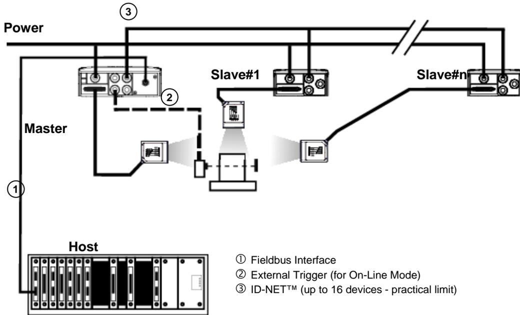
Figure 69 – ID-NET™ Fieldbus M/S Synchronized Layout
