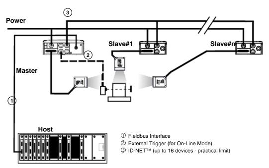
Figure 69 - ID-NET™ Fieldbus M/S Synchronized Layout
