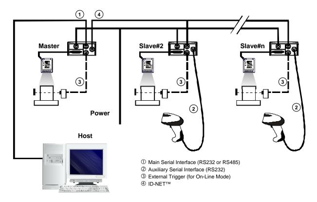
Figure 66 - Pass-Through On ID-NET™ Layout
