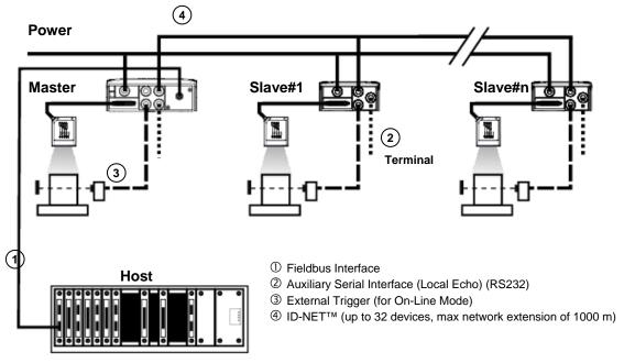
Figure 70 - ID-NET™ Fieldbus M/S Multidata
