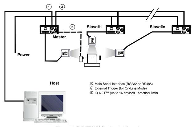
Figure 67 – ID-NET™ M/S Synchronized Layout
