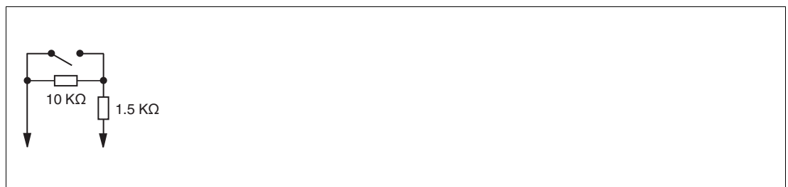
Abbildung 6.27 Mechanischer Kontakt mit zusätzlicher Widerstandsbeschaltung
