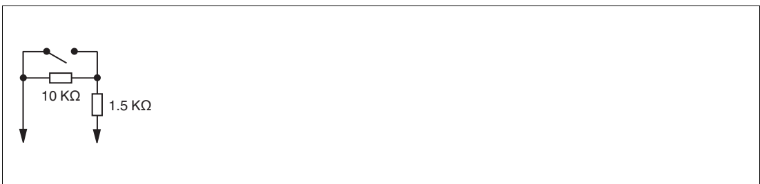
Abbildung 6.13 Mechanischer Kontakt mit zusätzlicher Widerstandsbeschaltung
