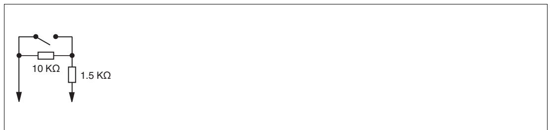
Abbildung 6.8 Mechanischer Kontakt mit zusätzlicher Widerstandsbeschaltung
