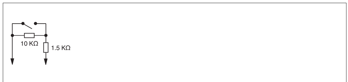
Abbildung 6.17 Mechanischer Kontakt mit zusätzlicher Widerstandsbeschaltung
