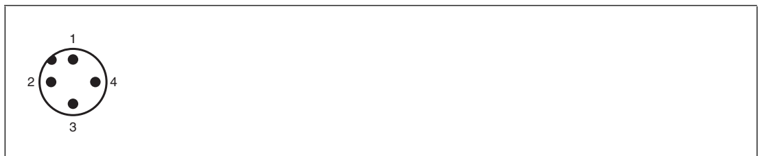
Abbildung 2.2 Externe Spannungsversorgung (M12-Stecker)
