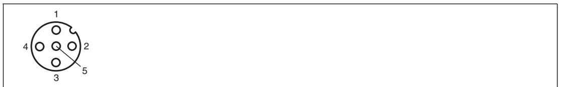
Figura 2.3 Conexión de esclavo (casquillo M12)
