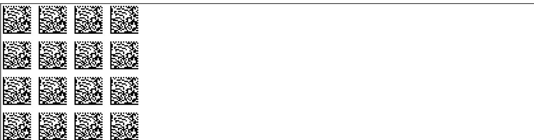
Abbildung 8.16 Die Codekarte weist dem Lesekopf automatisch die Orientierung 0^\circ , 90^\circ , 180^\circ oder 270^\circ zu.
