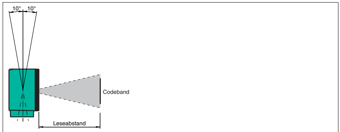
Abbildung 5.4 Toleranz vertikale Ausrichtung
