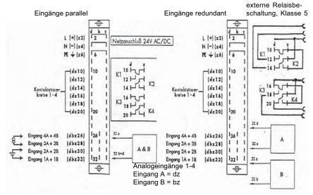
gebrückt dargestellte Anschlüsse (dz) sind intern verbunden Federleisten nach DIN 41 612 Bauform F
