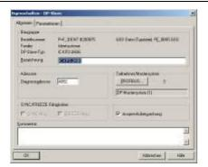
Die Länge der Diagnosedaten beträgt 48 Byte. Im Anwenderprogramm werden die Diagnosedaten innerhalb des DB2 abgelegt. Es ist zu empfehlen in das Steuerungsprogramm der Applikation diesen Diagnoseaufruf zu übernehmen. Dadurch lassen sich verschiedene Geräteparameter (u.a. Softwarestände) leicht abfragen. Nachfolgend ist das Beispiel zum Aufruf der Diagnose von der Adresse 4092 (=FFChex).
