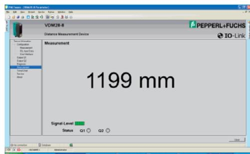
IO-LINK Master 모듈을 통하여 쉽게 파라미터 세팅 및 변위 상태 모니터링 등의 기능을 구현한다.
