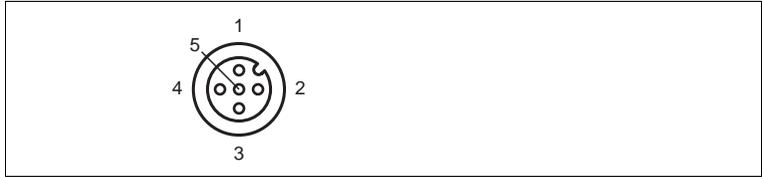
Abbildung 4.5 Anschlussbelegung Eingang Drehgeber
