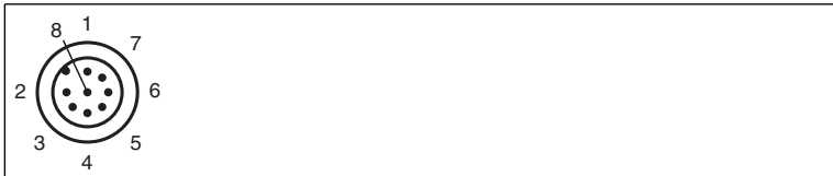
Abbildung 4.8 Anschlussbelegung Betriebsspannung und Eingänge und Ausgänge
