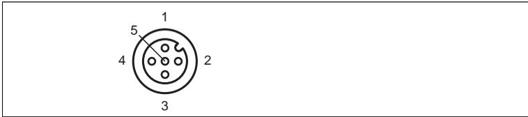
Abbildung 4.4 Anschlussbelegung Eingang RS 232
