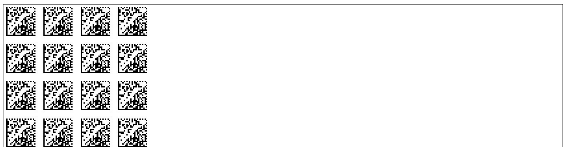
Abbildung 8.2 Die Codekarte "STORE" speichert die vorgenommene Parametrierung nichtflüchtig im Lesekopf und beendet die Betriebsart für externe Parametrierung.
