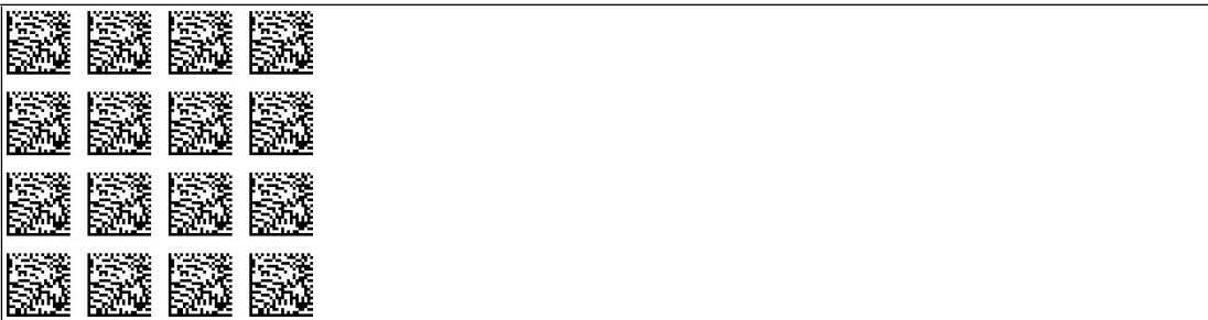
Abbildung 8.10 Die Codekarte weist dem Lesekopf eine Auflösung der Positionsdaten von 10 mm zu.
