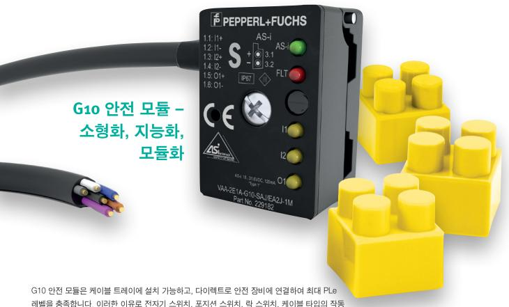
스위치로부터 비상 버튼, 도어 락 및 릴레이 출력의 라이트 커튼까지 전부 AS-Interface 안전 시스템에 통합할 수 있습니다. 플랫 케이블을 G10 안전 모듈에 삽입하고 양단을 맞춘다음 볼트를 조이면 설치가 완료됩니다.
