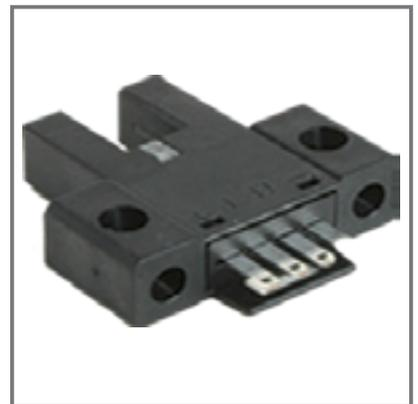
GL5 系列属于微型光电传感器，可用来精确检测微小物体。这个传感器可工作在较宽的电压范围 5 至 24 VDC，有非常高的开关频率 5 KHz。0.8 mm 的缝隙与超快速响应时间一起保证了目标检测的高精度。这个传感器可用于在线性导轨上的高精度停止位置检测，或者在齿轮凸轮上的高精度速度测量。
