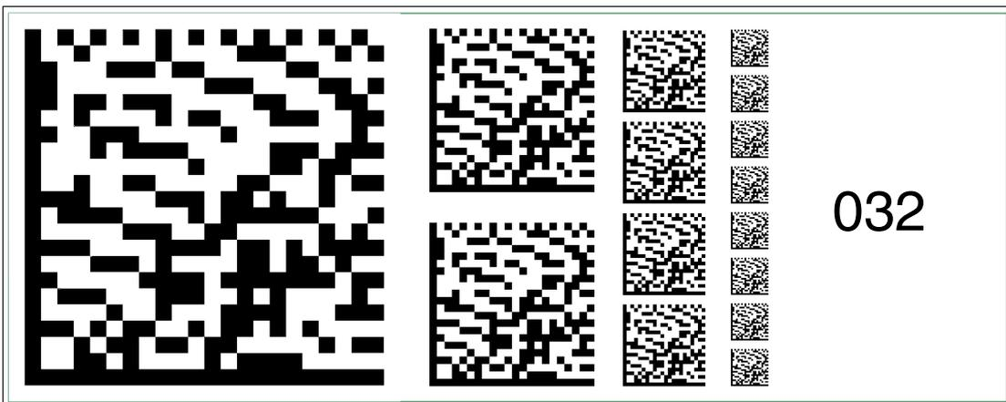
Abbildung 2.32 Die Codekarte "Feldbusadresse 032" weist dem Gerät die Feldbusadresse 032 zu.
