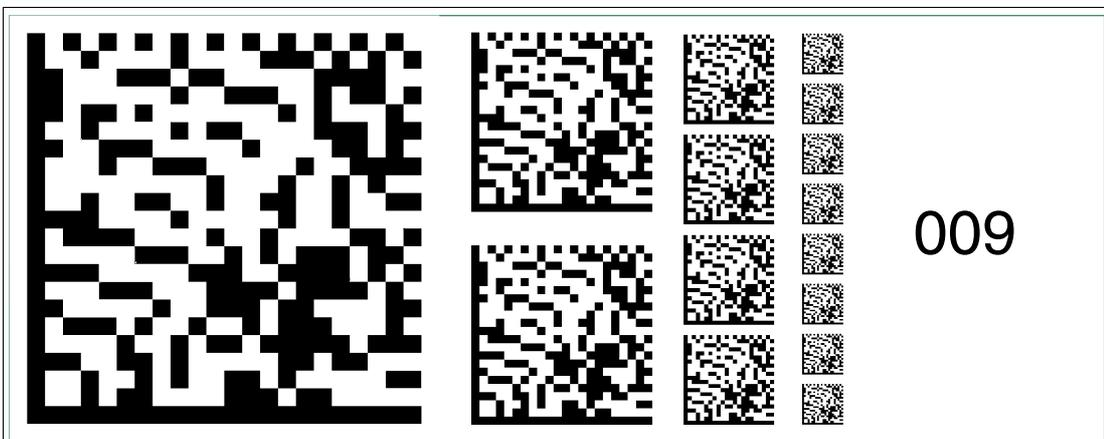
Abbildung 2.9 Die Codekarte "Feldbusadresse 009" weist dem Gerät die Feldbusadresse 009 zu.
