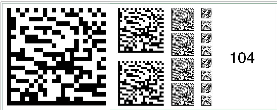
Abbildung 2.104 Die Codekarte "Feldbusadresse 104" weist dem Gerät die Feldbusadresse 104 zu.
