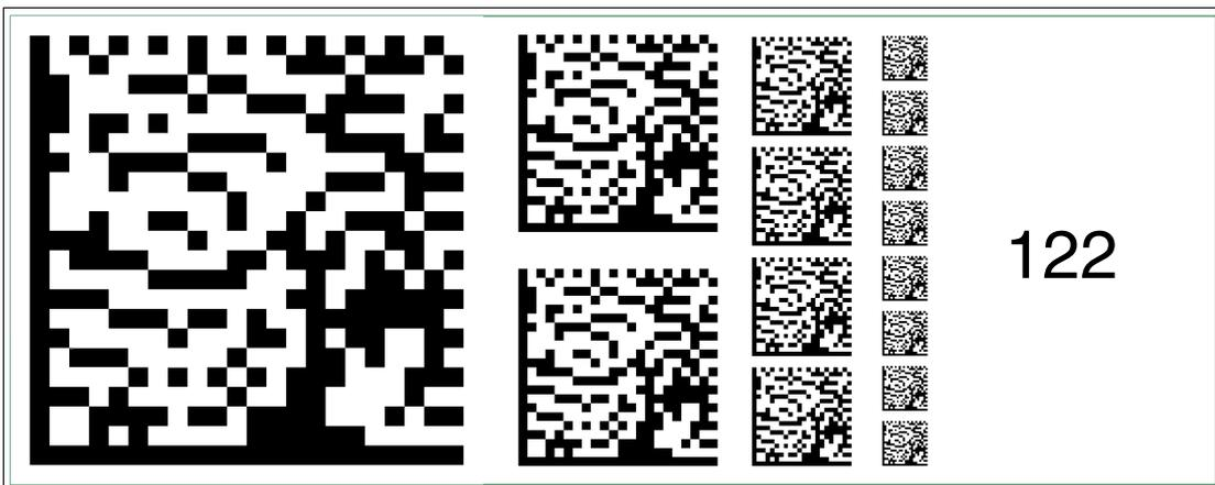
Abbildung 2.122 Die Codekarte "Feldbusadresse 122" weist dem Gerät die Feldbusadresse 122 zu.
