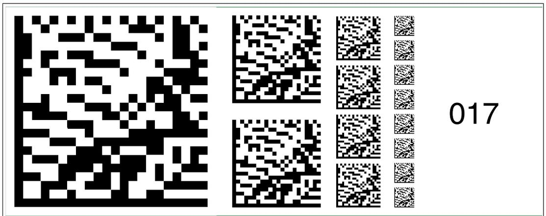
Abbildung 2.17 Die Codekarte "Feldbusadresse 017" weist dem Gerät die Feldbusadresse 017 zu.
