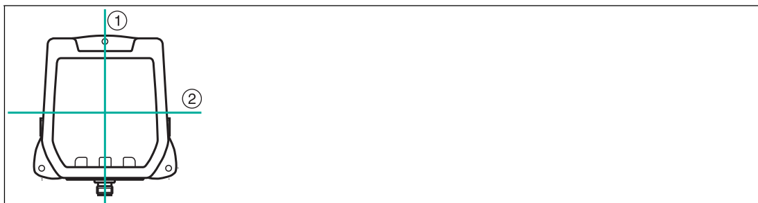
Abbildung 3.2 ① = vertikale Polarisationsebene ② = horizontale Polarisationsebene
