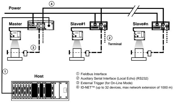
Figure 74 - ID-NET™ Fieldbus M/S Multidata
