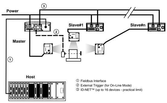
Figure 73 - ID-NET™ Fieldbus M/S Synchronized Layout
