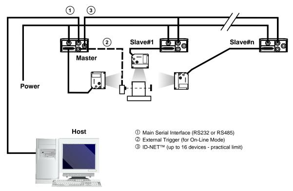
Figure 71 - ID-NET™ M/S Synchronized Layout
