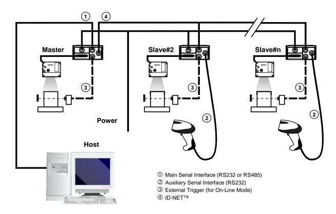
Figure 70 - Pass-Through On ID-NET™ Layout
