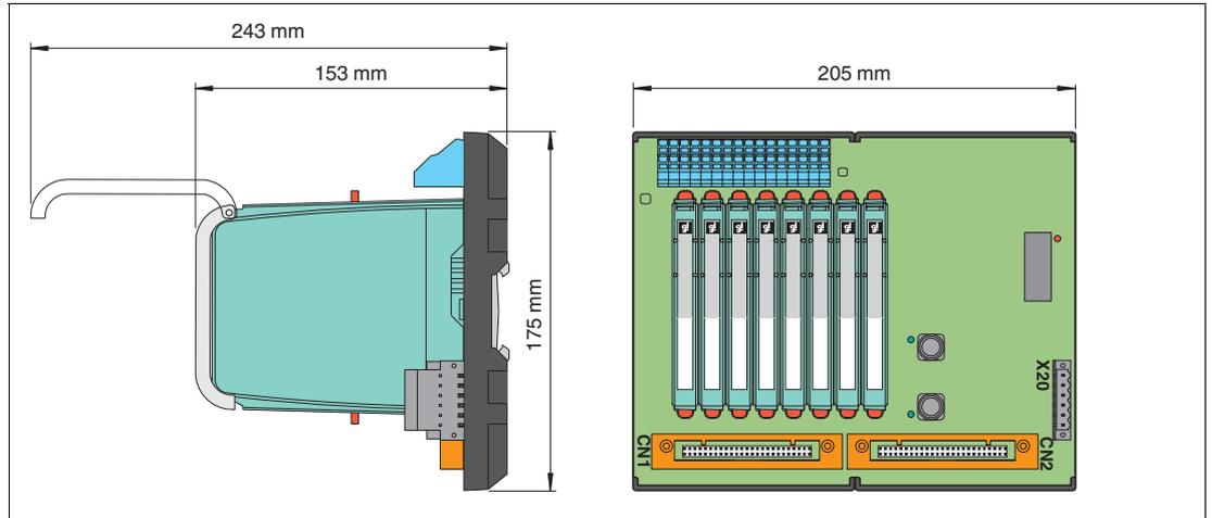
Abbildung 3.1 Abmessungen (B x H x T): 205 x 175 x 153 mm, Tiefe inklusive Modulbestückung
