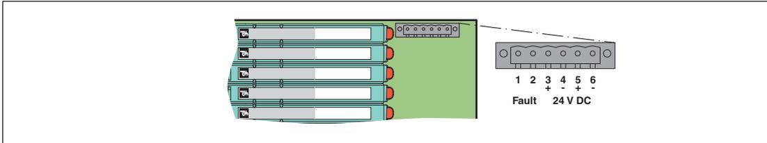
Abbildung 2.3 Anschluss von Versorgung und Fehlermeldeausgang über Schraubklemmen
