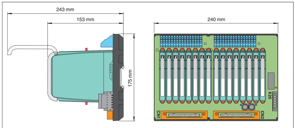
Abbildung 3.2 Abmessungen (B x H x T): 240 x 175 x 153 mm, Tiefe inklusive Modulbestückung
