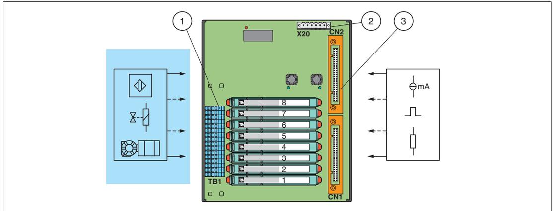
Abbildung 2.1 Anschlussbeispiel Termination Board mit 8 Steckplätzen
