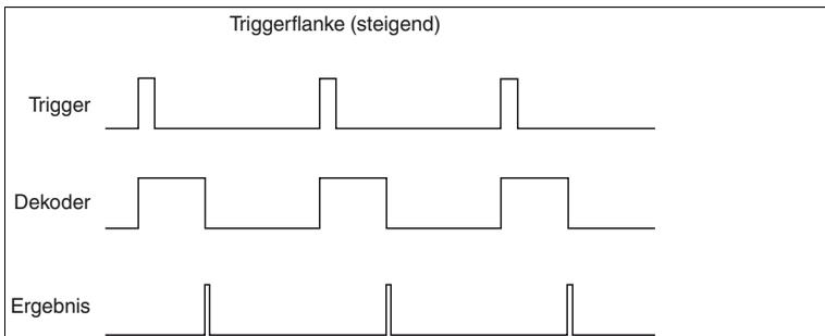
Abbildung 7.1 Impulsdiagramm Triggerflanke steigend
