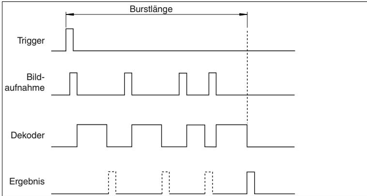
Abbildung 7.5 Impulsdiagramm Intervallbursttrigger
