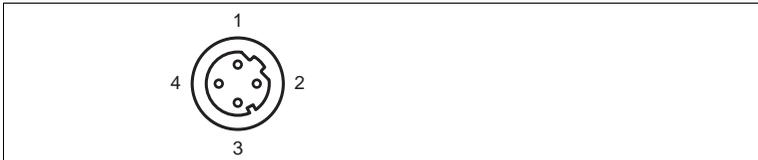
Abbildung 4.5 Anschlussbelegung Netzwerk
