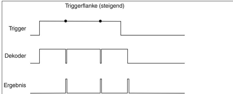
Abbildung 7.2 Impulsdiagramm Triggerflanke steigend und Pegel
