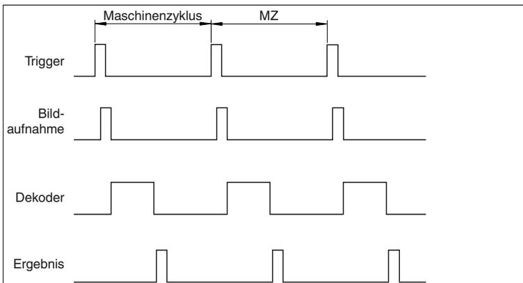
Abbildung 7.4 Impulsdiagramm Einzeltrigger
