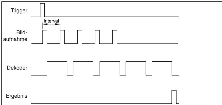
Abbildung 7.6 Impulsdiagramm Framebursttrigger
