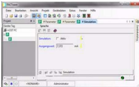
Sie können nun zu Testzwecken Ausgangsströme bzw. Ausgangsspannungen vorgeben. Drücken Sie Enter, um die numerische Vorgabe wirksam werden zu lassen.
