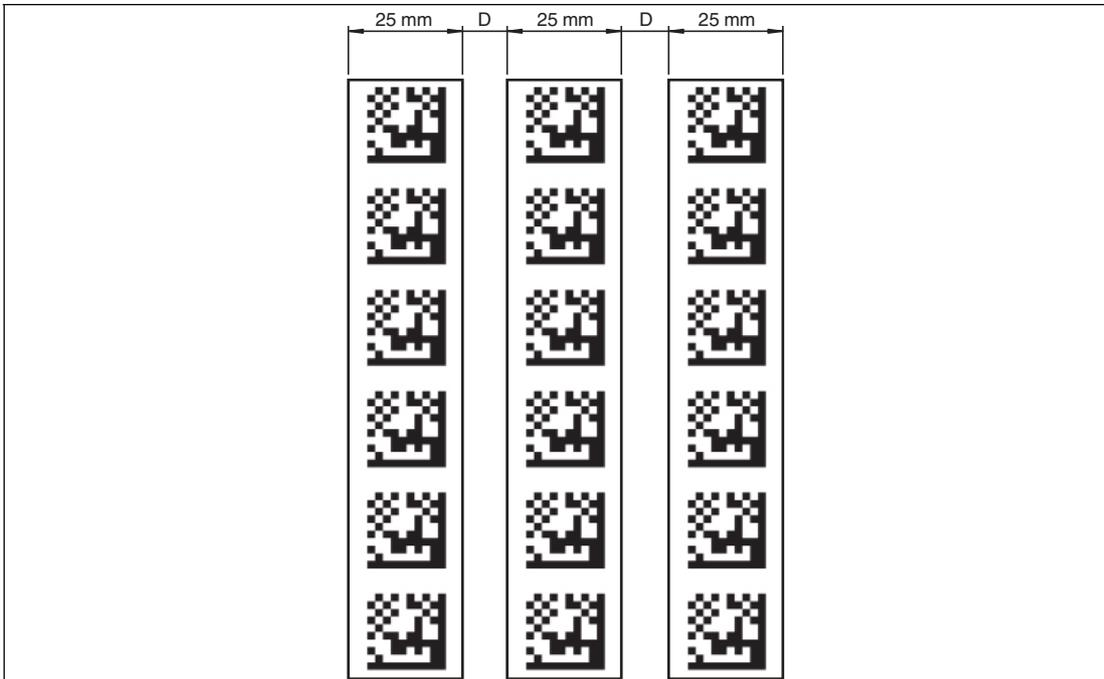
Figure 5.19  $0 \text{ mm} \leq D \leq 5 \text{ mm}$
