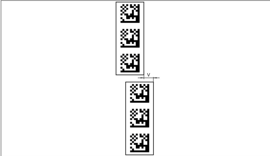
Figure 5.15 Offset:  $0 \text{ mm} \leq V \leq 5 \text{ mm}$
