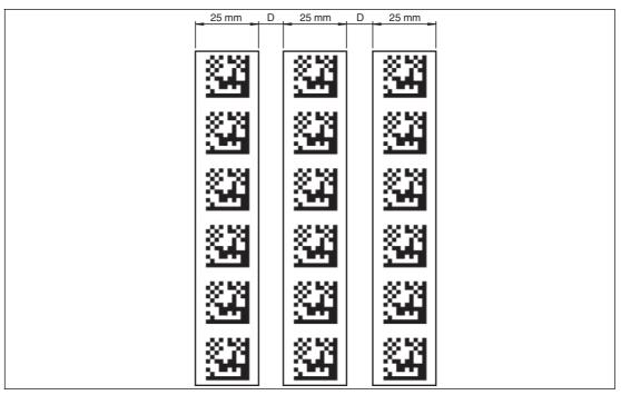
Figure 5.19  $0 \text{ mm} \le D \le 5 \text{ mm}$
