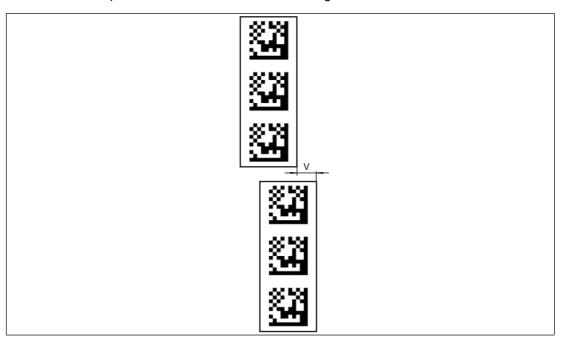
Figure 5.15 Offset:  $0 \text{ mm} \le V \le 5 \text{ mm}$
