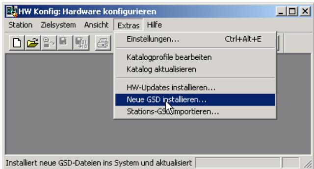
Nach Anwahl des Menüpunkts „Neue GSD installieren“ öffnet sich ein Dateidialogfenster in dem die zu installierende GSD-Datei ausgewählt werden kann.
