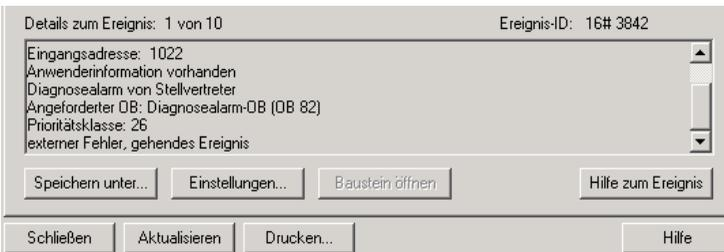
Das Eintragen der Fehlermeldungen im Diagnosepuffer der CPU und das Aufrufen des OB82 ist eine Folge des gesetzten ExtDiag-Flags bei aufgetretenem Fehler im AS-i/DP-Gateway.
