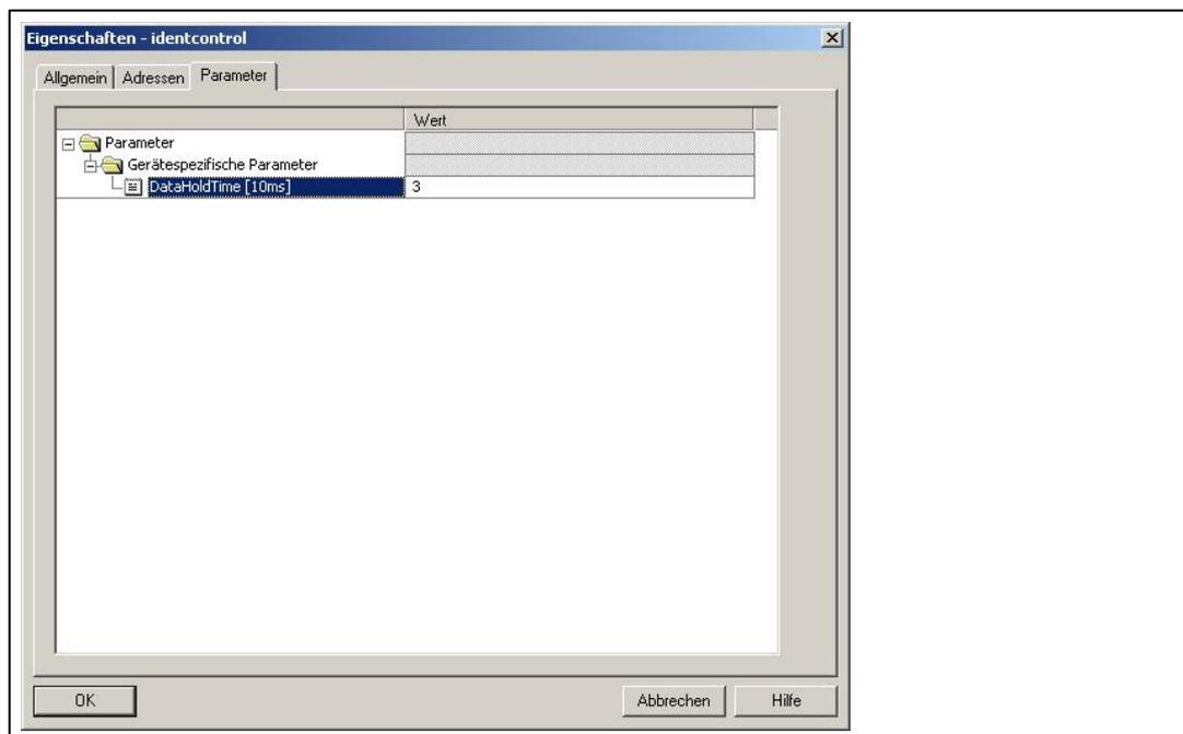
Der gerätespezifische Parameter „Data Hold Time“ (DHT) beschreibt die Datenhaltezeit innerhalb des Ausgangsdatenfeldes der IDENTControl. Die DHT sollte den doppelten Wert der Zykluszeit der Steuerung aufweisen. Hierbei gilt zu beachten, dass der Wert der DHT ein Vielfaches von 10ms darstellt. Beträgt die Zykluszeit innerhalb der Steuerung rund 20ms, so sollte ein Wert der DHT von mindestens 4 gewählt werden.
