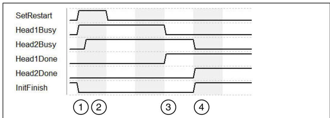
1. „SetRestart“ löst Initialisierungsroutine aus. Initialisierung erfolgt an Kopf 1 „Head1Busy“.
