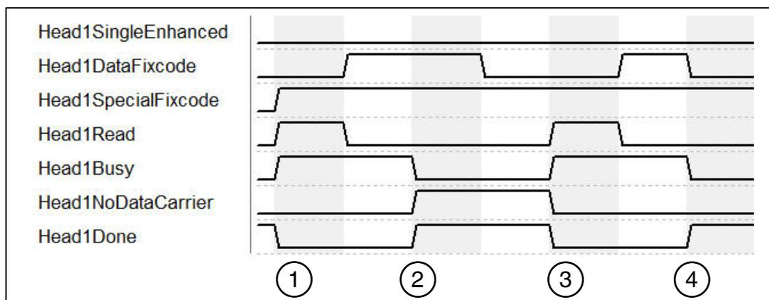
1. „Head1SingleEnhanced“ ist nullaktiv, um einen Single-Befehl zu initialisieren. „Head1DataFixcode“ ist irrelevant, da „Head1SpecialFixcode“ höher priorisiert ist als Words oder Fixcode (d.h. sobald „Head1SpecialFixcode“ TRUE ist, ist „Head1DataFixcode“ hinfällig). „Head1SpecialFixcode“ ist TRUE, um auf den SpecialFixcode/EPC zuzugreifen. Single Read SpecialFixcode wird gestartet, in dem „Head1Read“ auf TRUE wechselt. „Head1Busy“ wechselt auf TRUE, zeitgleich geht „Head1Done“ auf FALSE.
