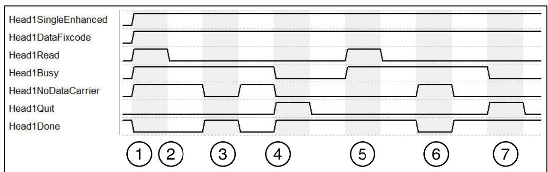
1. „Head1SingleEnhanced“ ist TRUE, um einen Enhanced-Befehl zu initialisieren. „Head1DataFixcode“ ist TRUE, um auf den Fixcode/TID zuzugreifen. Enhanced Read Fixcode wird gestartet „Head1Read“ ist TRUE. „Head1Busy“ wechselt auf TRUE, zeitgleich geht „Head1Done“ auf FALSE.
