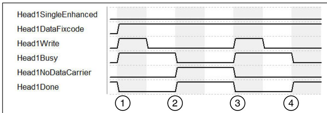
1. „Head1SingleEnhanced“ ist nullaktiv, um einen Single-Befehl zu initialisieren. „Head1DataFixcode“ ist TRUE, um auf den Fixcode/TID zuzugreifen. Single Write
