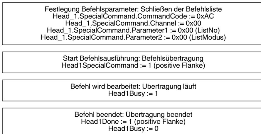
Die Befehlsliste wird ausgeführt, sobald diese aktiviert wird. Die Aktivierung kann im Single oder Enhanced Modus erfolgen.
