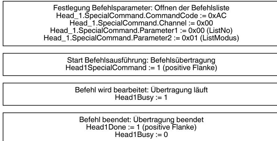
Nach dem Öffnen der Befehlsliste werden die auszuführenden Befehle durch den SpecialCommand an die Auswerteeinheit übertragen. Nachfolgend werden zunächst der Befehl Enhanced Read Fixcode und anschließend der Befehl Enhanced Read Words parametrisiert.
