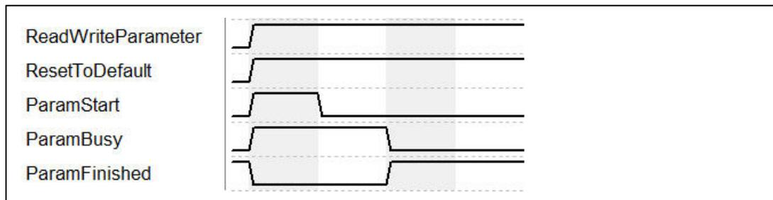
Nachdem der Befehl mit „ParamStart“ angestoßen wurde signalisiert „ParamBusy“, dass die Befehlsabarbeitung im Gange ist. „ParamFinished“ wechselt während dieser Zeit auf FALSE. Nach dem der Befehl beendet ist geht „ParamFinished“ wieder auf TRUE.
