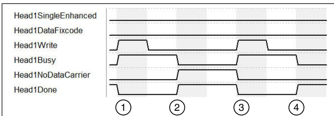
1. „Head1SingleEnhanced“ ist nullaktiv, um einen Single-Befehl zu initialisieren. „Head1DataFixcode“ ist FALSE, um auf Words/User-Data zuzugreifen. Single Write Words wird gestartet, in dem „Head1Write“ auf TRUE wechselt. „Head1Busy“ wechselt auf TRUE, zeitgleich geht „Head1Done“ auf FALSE.
