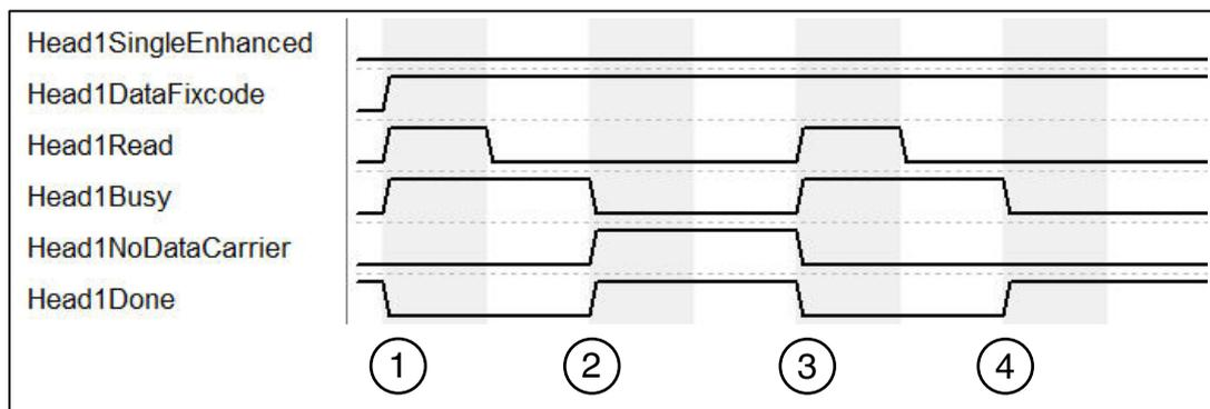
1. „Head1SingleEnhanced“ ist nullaktiv, um einen Single-Befehl zu initialisieren. „Head1DataFixcode“ ist TRUE, um auf den Fixcode/TID zuzugreifen. Single Read Fixcode wird gestartet, in dem „Head1Read“ auf TRUE wechselt. „Head1Busy“ wechselt auf TRUE, zeitgleich geht „Head1Done“ auf FALSE.
