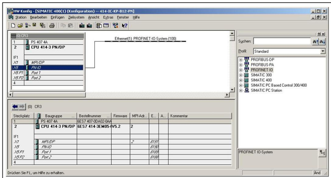
Anschließend erfolgt die Anbindung der IDENTControl an das Profinet-IO System. Dazu muss das Symbol „IC-KP-B12“ (bzw. „IC-KP-B17“) aus den Hardwarekatalog via „Drag n´Drop“ auf das Mastersystem gezogen werden. Anschließend wird die Telegrammlänge durch die Kommunikationsmodule (z.B. In/Out 64 Byte) definiert. Das Modul muss einen Slot zugewiesen werden.
