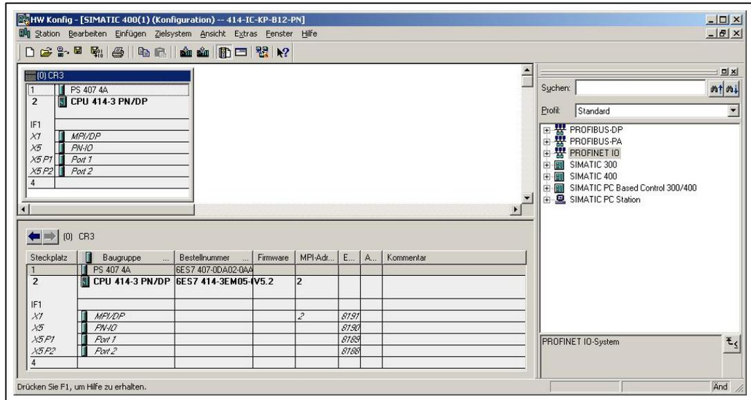
Anschließend wird durch Rechtsklick auf den Profinetport ein Profinet-IO System eingefügt werden.
