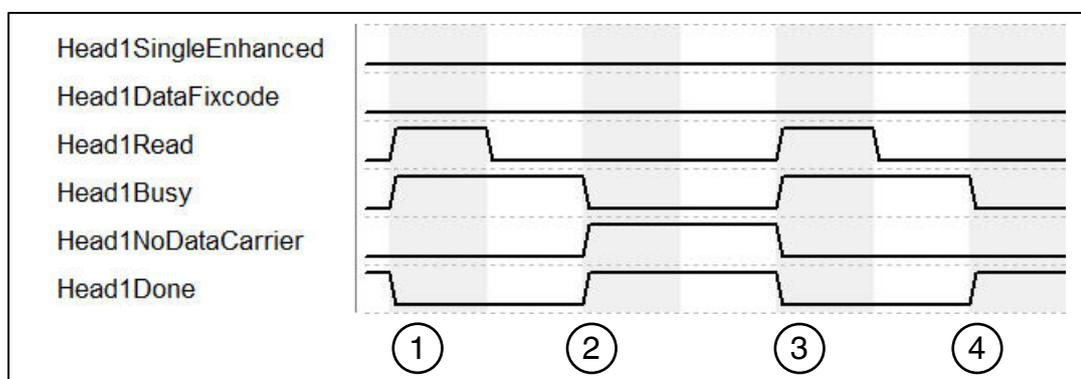
1. „Head1SingleEnhanced“ ist nullaktiv, um einen Single-Befehl zu initialisieren. „Head1DataFixcode“ ist FALSE, um auf Words/User-Data zuzugreifen. Single Read Words wird gestartet, in dem „Head1Read“ auf TRUE wechselt. „Head1Busy“ wechselt auf TRUE, zeitgleich geht „Head1Done“ auf FALSE.
