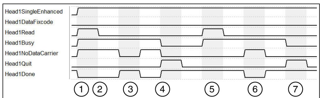
1. "Head1SingleEnhanced" ist TRUE, um einen Enhanced-Befehl zu initialisieren. „Head1DataFixcode“ ist FALSE, um auf Words/User-Data zuzugreifen. Enhanced Read Words wird gestartet „Head1Read“ ist TRUE. „Head1Busy“ wechselt auf TRUE, zeitgleich geht „Head1Done“ auf FALSE.
