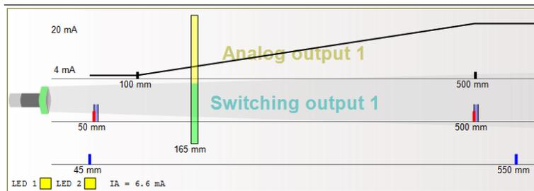
图形界面显示了当前传感器模拟量设置的边界 100mm 处 4mA，500mm 处 20mA，开关点近点为 50mm，远点为 500mm。
