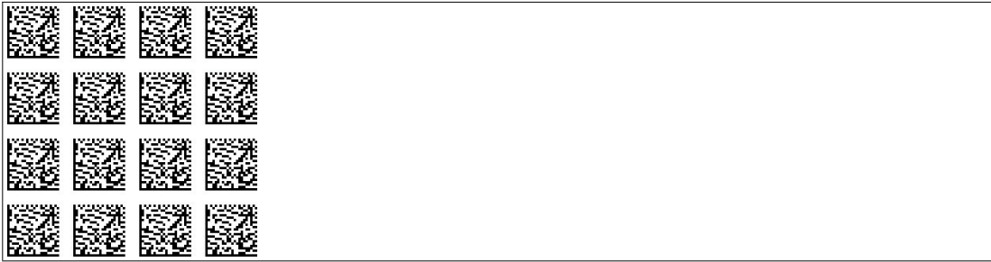
Abbildung 6.11 Die Codekarte weist dem Lesekopf die Baudrate 500 kBaud zu
