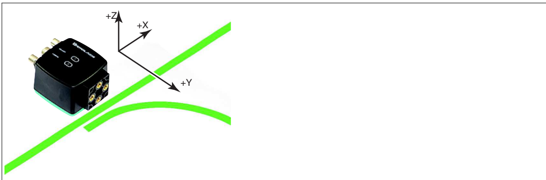
Abbildung 3.3 Sichtfeld und Koordinaten des Sensors
