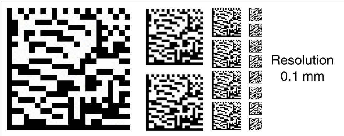
Abbildung 6.10 Die Codekarte weist dem Lesekopf eine Auflösung der Positionsdaten von 0,1 mm zu.
