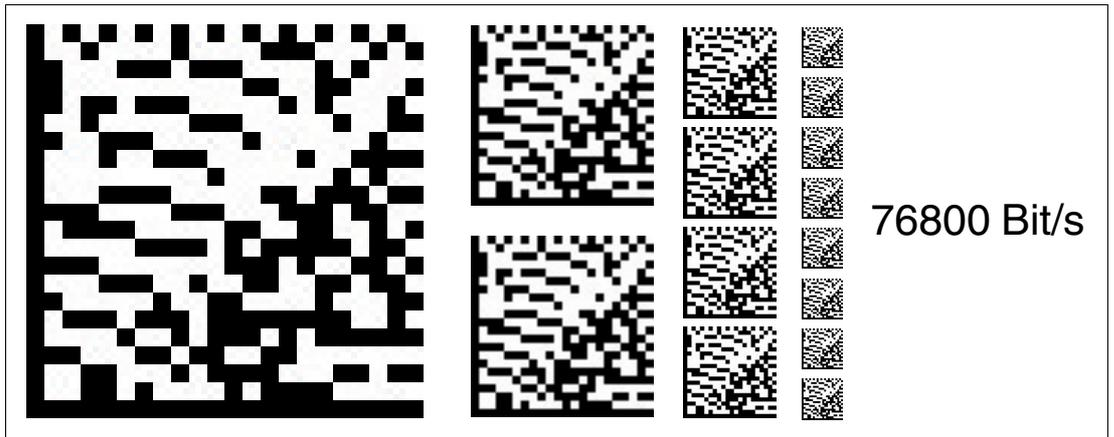
Abbildung 6.15 Die Übertragungsrate des Lesekopfs für die Kommunikation über die Schnittstelle wird auf 76800 Bit/s eingestellt.
