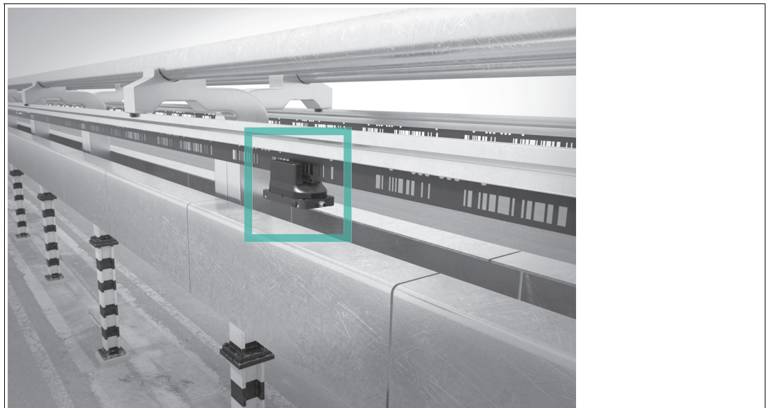
Abbildung 2.5 Stromschiene eines Portalkrans
