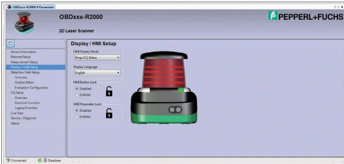
Im Fenster **Display / HMI Setup** legen Sie die optische Rückmeldung des Laserscanner-Displays fest und steuern die Freigabe/Sperrung der Bedientasten und -funktionen.
