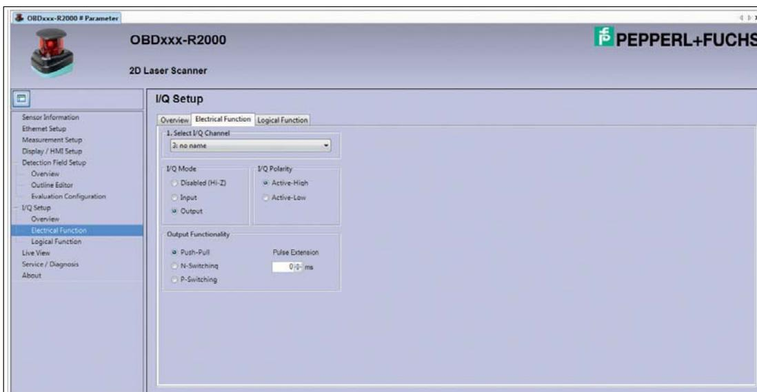
Auf der Registerseite **Electrical Function** definieren Sie Ausgangs- und Eingangssignale. Für jedes Eingangs-/Ausgangssignal können weitere Einstellungen vorgenommen werden.
