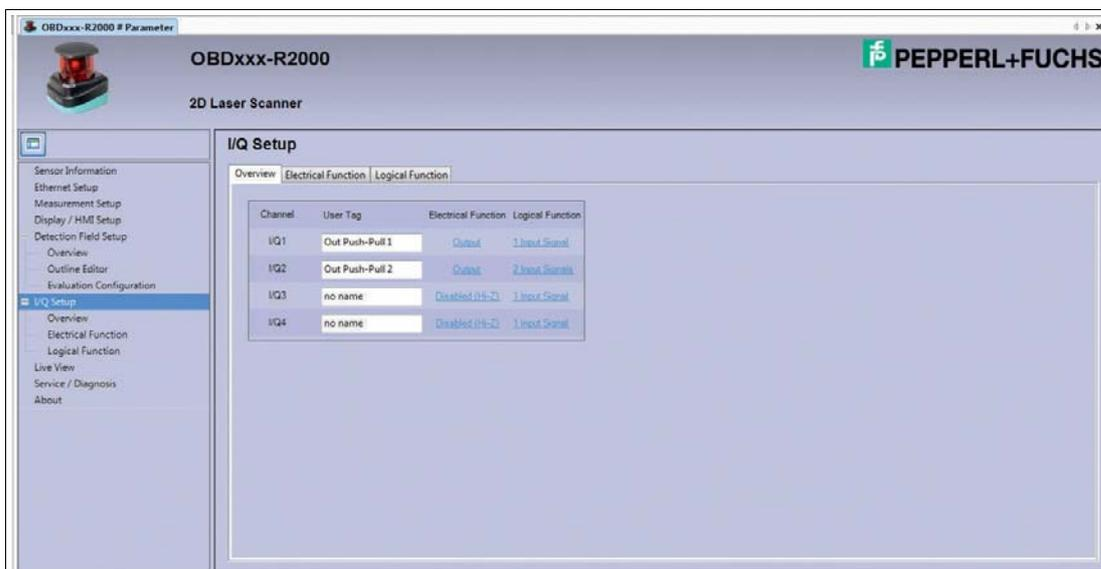
Das Fenster **I/Q Setup** enthält 3 Registerseiten:
