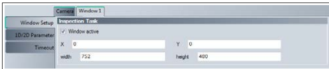
Abbildung 5.4 Parametrierbereich Window 1 - Window Setup
