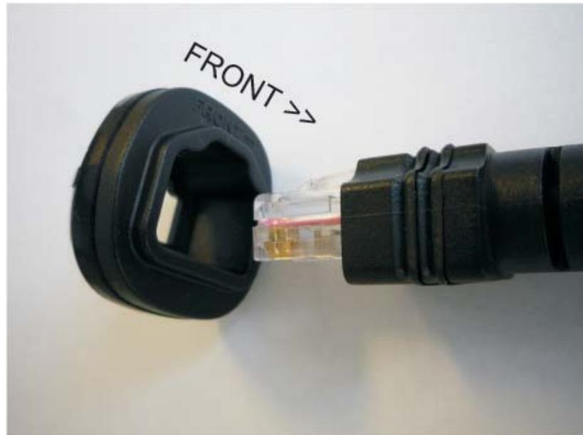
5. Schieben Sie das Kabel mit Plastik Schutzmanschette (2) mit der Dichtung (1) in den Barcodelesergriff. Stellen Sie sicher, dass die "FRONT>>" Markierung an der Kunststoff Schutzmanschette (2) sichtbar bleibt und dass die Pfeilmarkierung zur Front des Barcodeleseres zeigt.
