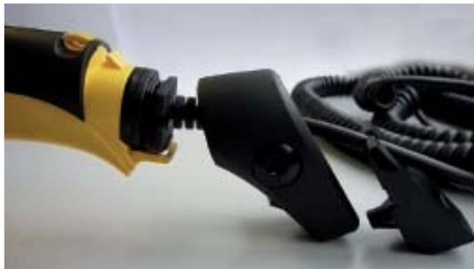
4. Ziehen Sie den Stecker aus dem Barcodelesergriff und ziehen Sie die Kunststoff Schutzmanschette und die Dichtung ab.
