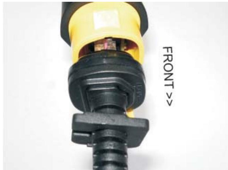
6. Stecken Sie die Kabel Abstandsscheibe (3) auf das Kabel und schieben Sie diese in Richtung Barcodeleser.
