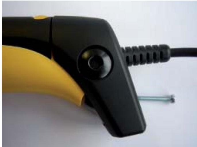
3. Schieben Sie zuerst die Zugentlastung und dann die Abdeckung über die gelbe Nase runter. Schieben Sie die Kabelabstandsscheibe runter.
