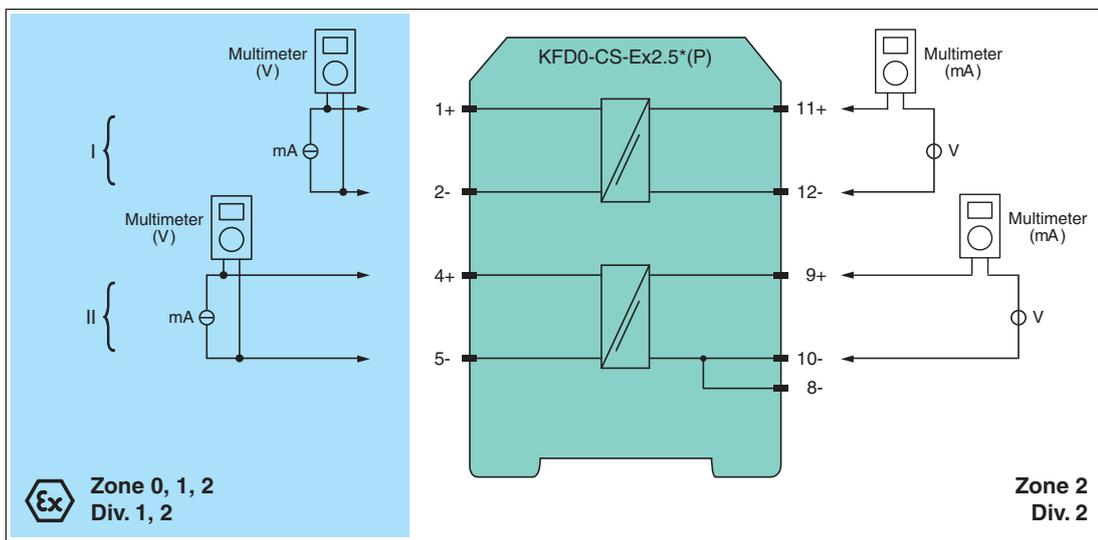
Abbildung 5.1 Aufbau Wiederholungsprüfung für KFD0-CS-(Ex)\*.5\*(P) bei Anschluss einer Stromquelle
