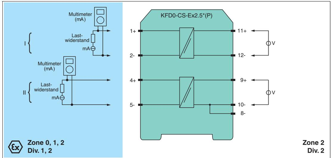
Abbildung 5.2 Aufbau Wiederholungsprüfung für KFD0-CS-(Ex)\*.5\*(P) bei Anschluss eines Lastwiderstands
