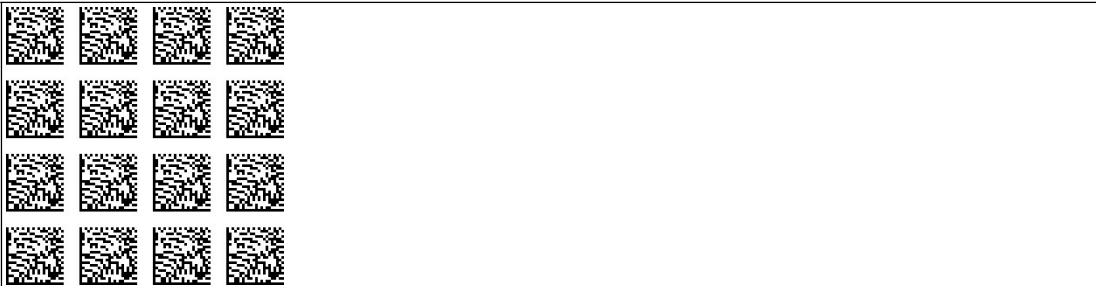
Abbildung 8.8 Die Codekarte weist dem Lesekopf eine Auflösung der Positionsdaten von 10 mm zu.
