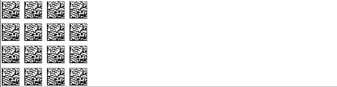
Abbildung 8.6 Die Codekarte weist dem Lesekopf eine Auflösung der Positionsdaten von 0,1 mm zu.
