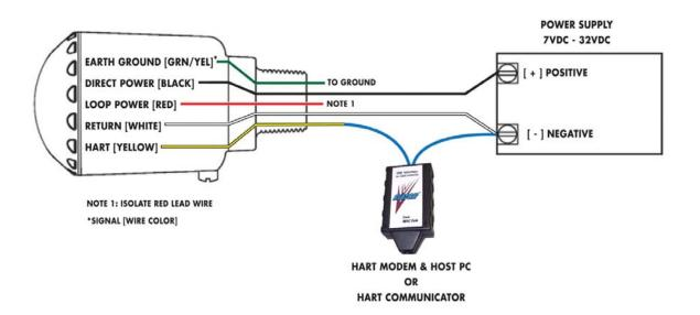
FIGURE 1: BENCH TOP CONFIGURATION SETUP
